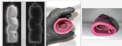
Figura 1. Diseño del molde mediante técnicas de impresión 3d (izquierda) y desarrollo del modelo de silicona.
